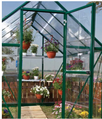
A nagy, pántos ajtó jobb és baloldalon is felszerelhető.
