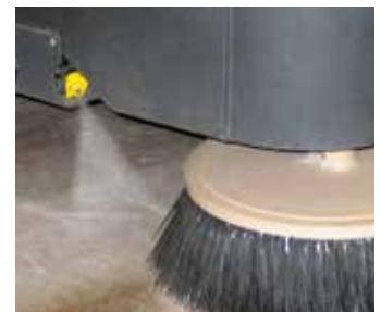
DUSTGUARD™ PORMEGKÖTŐ Megköti a felszálló port az oldalkeféknél
