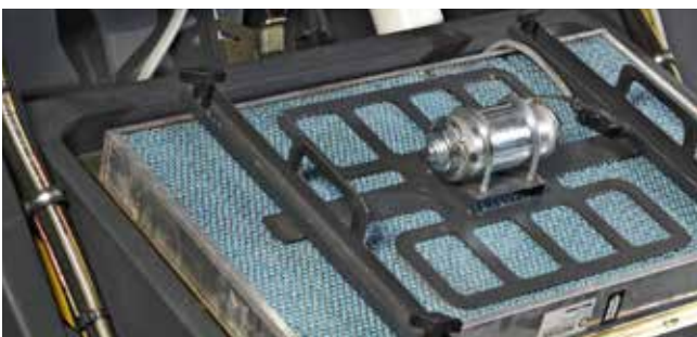
SZŰRŐK Papír szűrő: Száraz, nagyon poros közegben működik jól. Poliészter: Kiváló nyirkos alkalmazásokkor, mosható, száradás után újra használható
