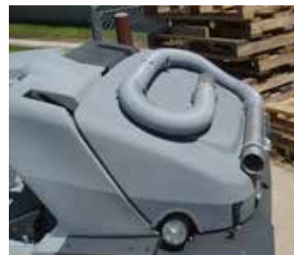
HULLADÉK PORSZÍVÓ Nehezen elérhető helyek tisztításához, mint raklapok, lépcsők, polcok alatt, stb.
